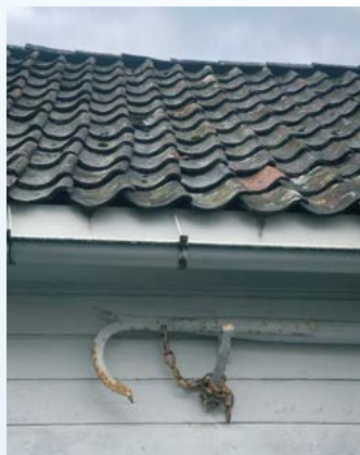
Рис. 9. Інструмент для розбирання частин дерев'яної панелі або конструкції. Джерело: Норвезький інститут досліджень культурної спадщини
