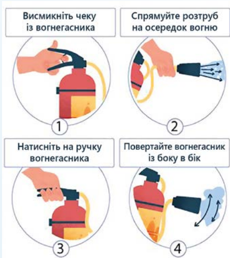
Рис. 10. Як користуватися вогнегасником.
